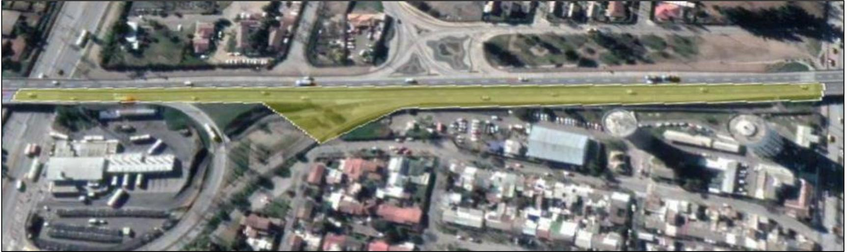
**Sector sur poniente; las obras en este sector apuntan básicamente a mejorar la actual pista de incorporación a la Ruta 5. Para ello es necesario proyectar muros de contención para el posterior ensanche y extensión de la pista de aceleración.**
