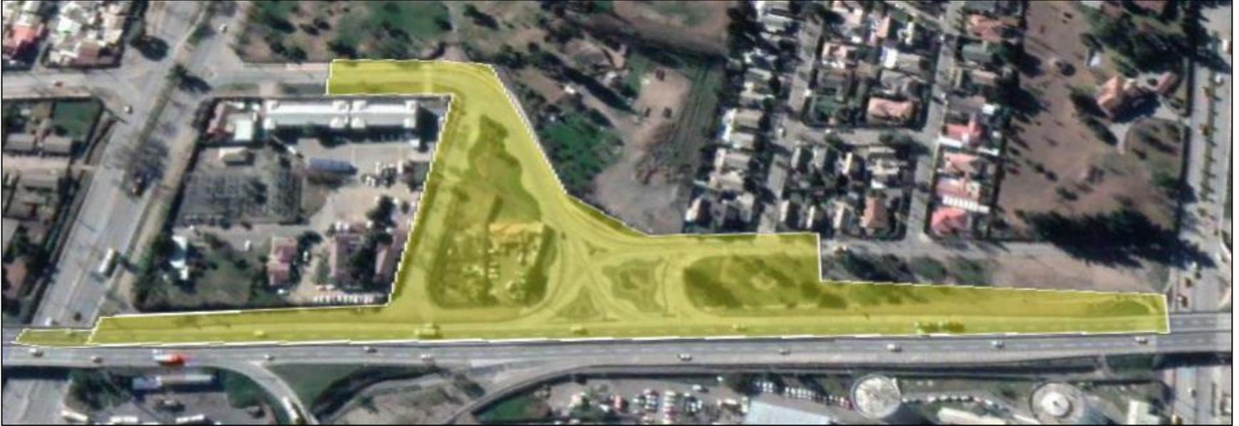
**Sector sur oriente; se proyectó una reposición de pavimento con mejoras menores en el trazado, en especial de un sector al que convergen múltiples movimientos entre ellos un acceso a la Ruta 5 en dirección al norte.**
