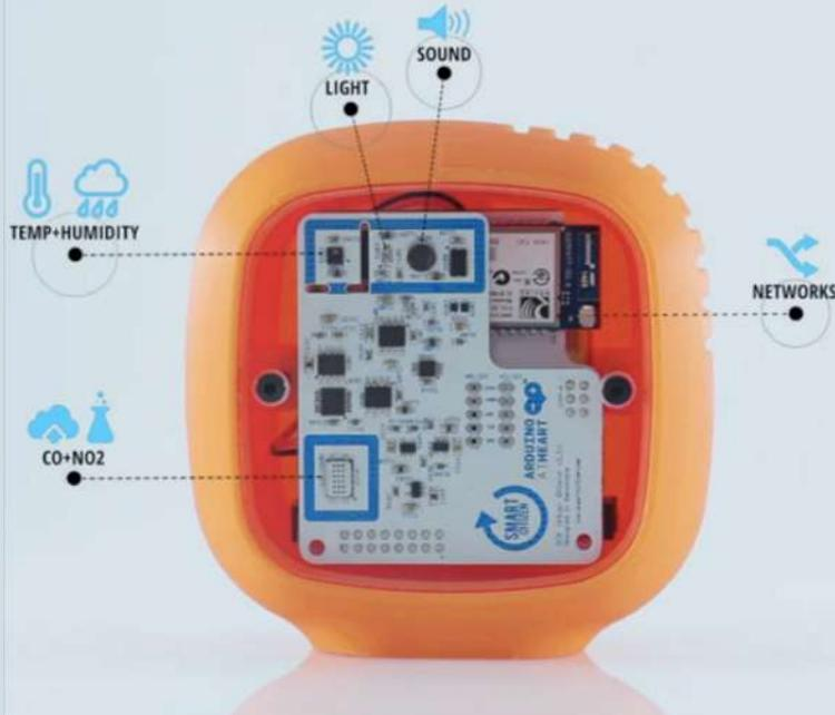
Durante el piloto de calles compartidas se aplica la herramienta Smart Citizen Kit, el cual con placas Arduino y sensores ambientales permite medir niveles de CO<sub>2</sub>, NO<sub>2</sub>, T°, humedad, ruido, entre otros.
